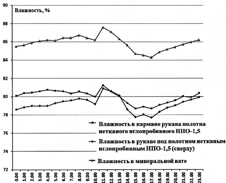
Рисунок 3 - Суточная влажность воздуха в зоне корневой системы томата в зависимости от видов материала, расположенного в технологическом рукаве (среднее за период с 09.05.2012 по 01.07.2012 г.)
